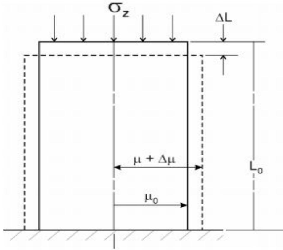
Эластичный цилиндр без ограничения бокового напряжения, опирающийся на плоскую поверхность и подвергают вертикальному сжимающему напряжению (lbs./in<sup>2</sup>).
