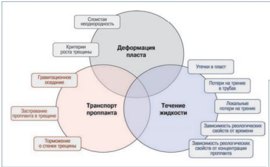
Рис. 1. Основные математические подмодели симулятора ГРП
