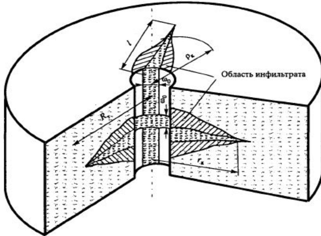
Рис. 5.4. Схема горизонтальной и вертикальной трещин
