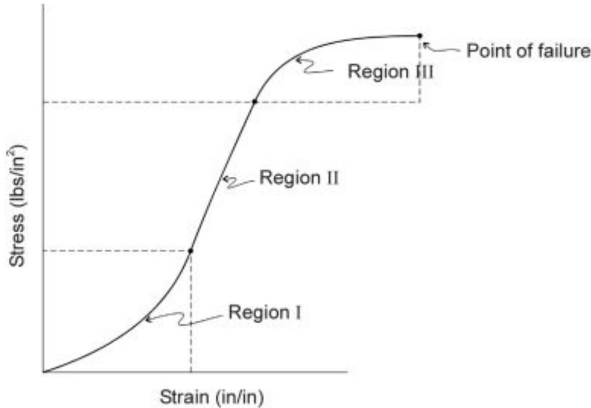
Стресс-деформация связи породы. Регион I: пластическая деформация вызванных закрытием микроразрушений. Регион II: Упругое сжатие материала рок-матрицы. Регион III: Пластическая деформация, вызванная микроразрушением в ответ на приложенное напряжение до тех пор, пока не произойдет сбой.
