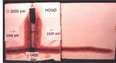
Рис. 8— Образец породы после гидроразрыва с перевернутой Т-образной трещиной.
