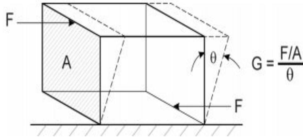
Модуль сдвига представляет собой отношение напряжения сдвига к углу деформации ( $\theta$ , выраженной в радианах).
