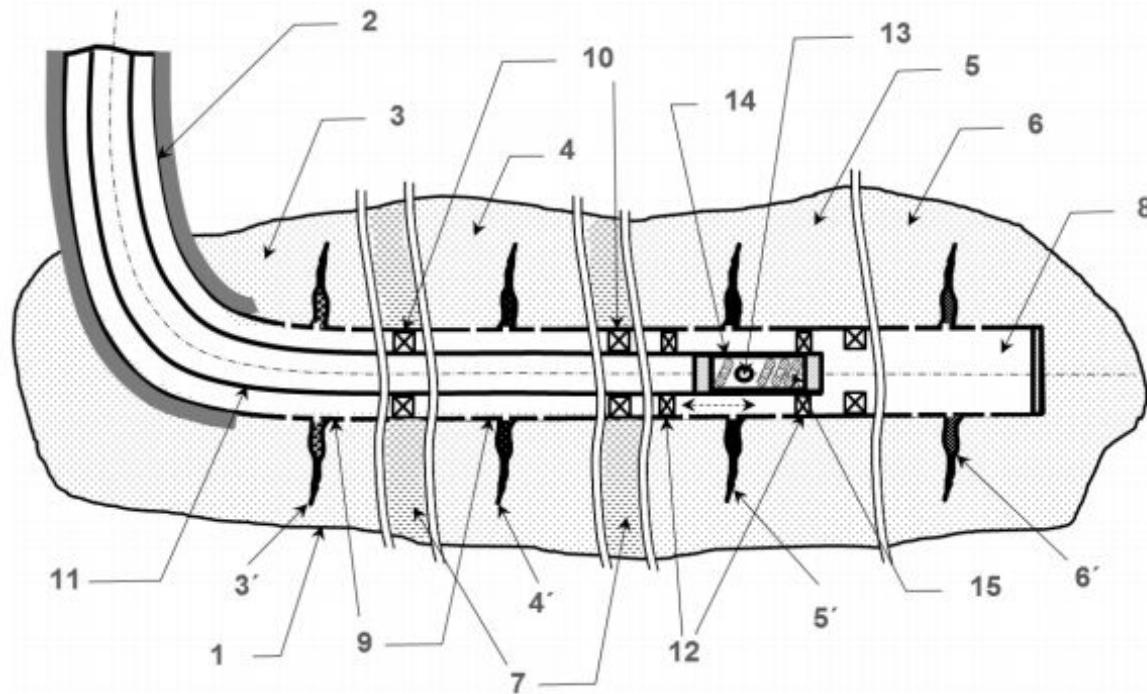
1 – продуктивный пласт, 2 – горизонтальная скважина, 3-6 – интервалы пласта с различной проницаемостью, 3'-6' – трещины ГРП, 7 – не коллектор, 8 – хвостовик, 9 – фильтры, 10 – водонабухающие пакеры, 11 – насосно-компрессорная труба, 12 – сдвоенные пакеры, 13 – радиальные отверстия гидравлического клапана, 14 – гидравлический клапан, 15 – поршневой и пружинный механизм.
