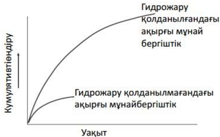
Сурет 2. Өткізгіштігі төмен қабаттардан мұнай өндіріс
