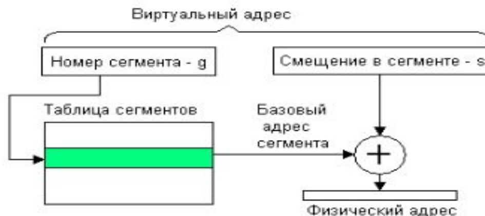
Рис. 3.14. Преобразование виртуального адреса при сегментной организации памяти
