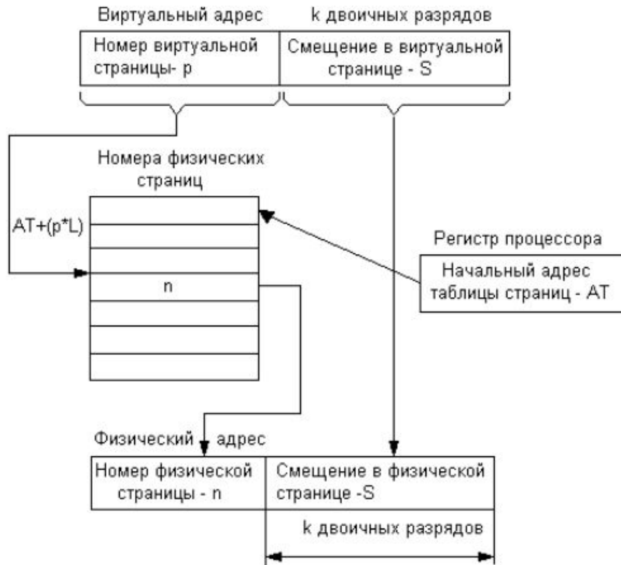
Рис. 3.12. Схема преобразования виртуального адреса в физический
