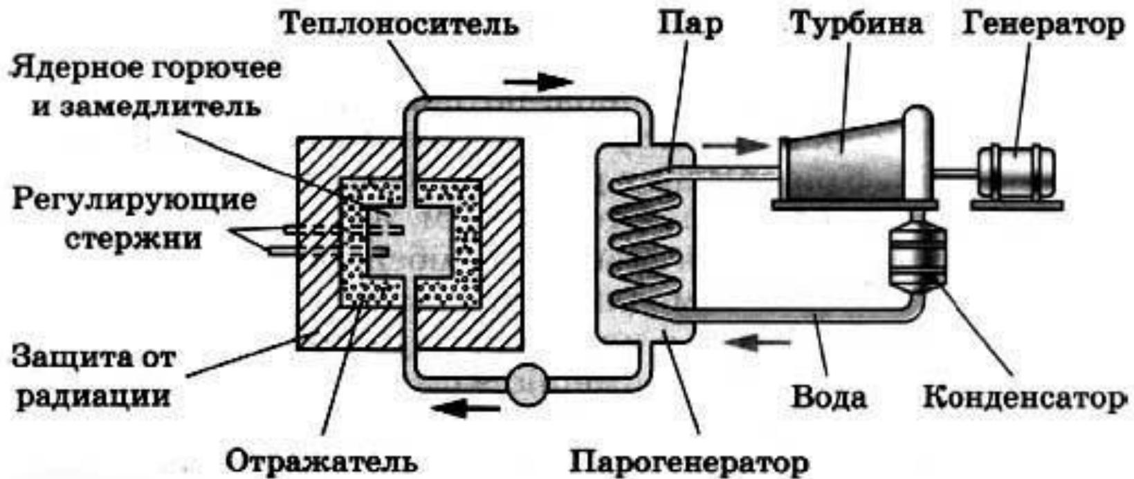
Рисунок 3. Схема энергетической установки с ядерным реактором.
