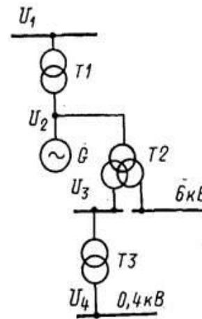
Рисунок 7. Упрощенная схема энергоблока генератор-трансформатор
