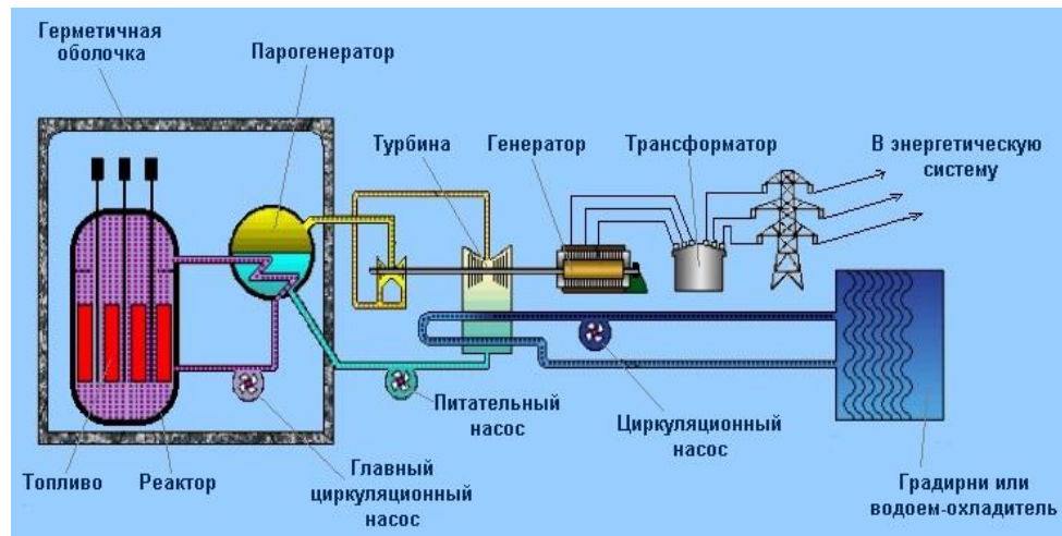
Рисунок 5. Устройство современного ядерного реактора. [5(1)]
