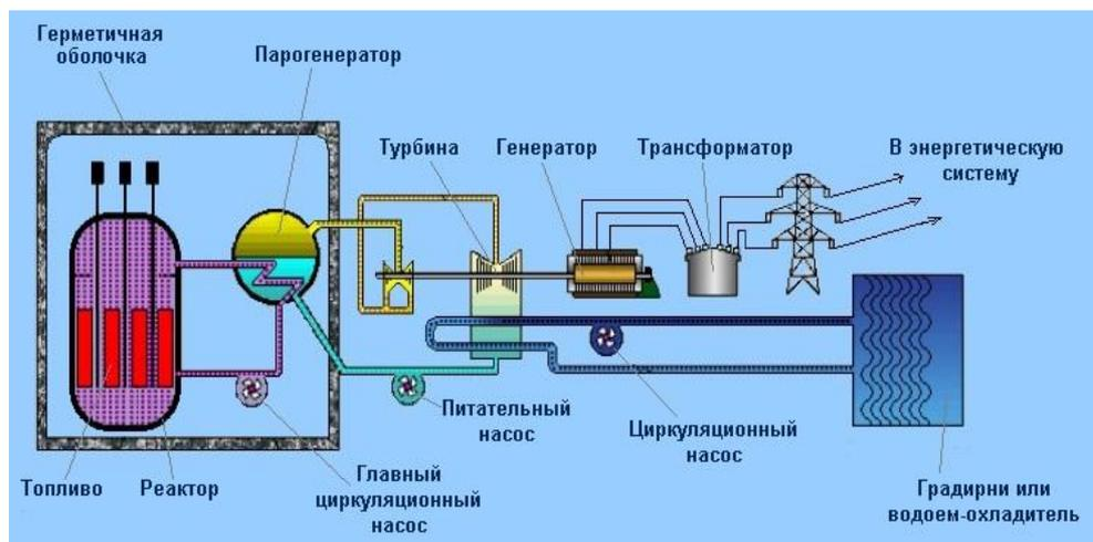
Рисунок 5. Устройство современного ядерного реактора. [5(1)]
