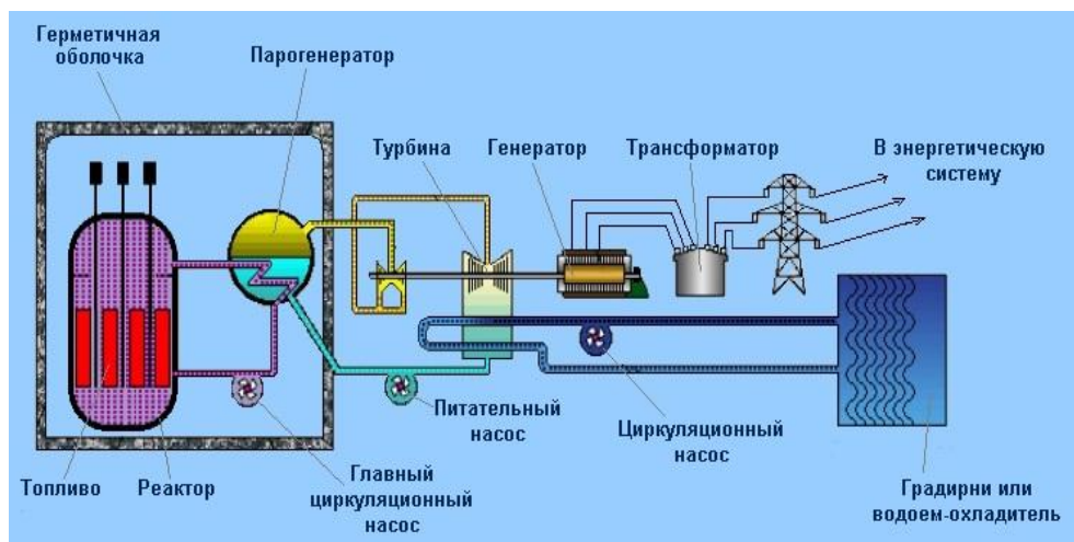
Рисунок 5. Устройство современного ядерного реактора. [5(1)]
