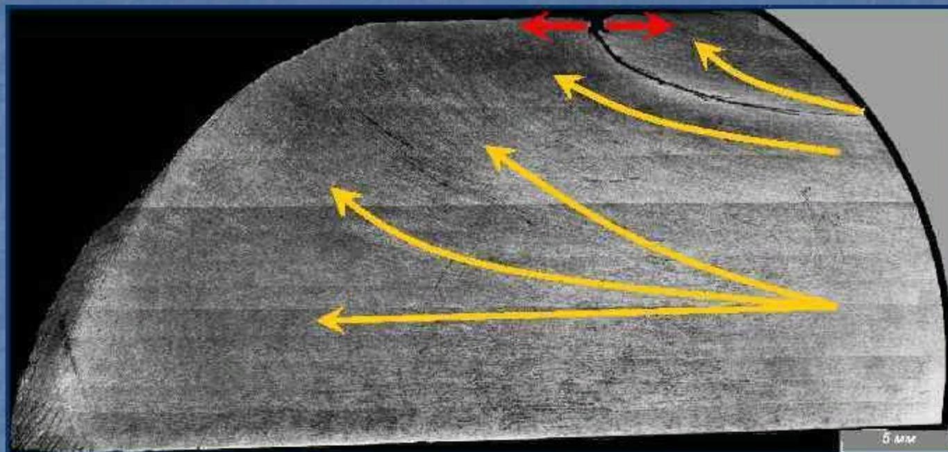
Грубые трещины при дальнейшем раскрытии волосовин
