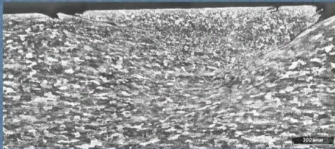
Панорамное изображение дефекта "светлая полоса с надрывами", образованная из-за раската механических повреждений и неровностей поверхности листа
