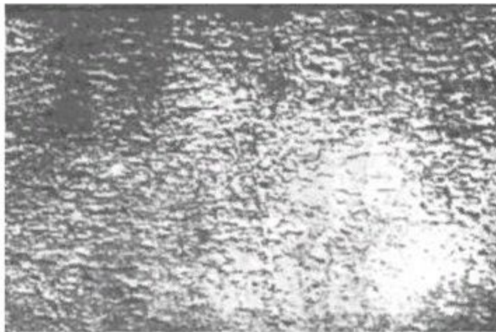
Поверхность прутка с рябизной
