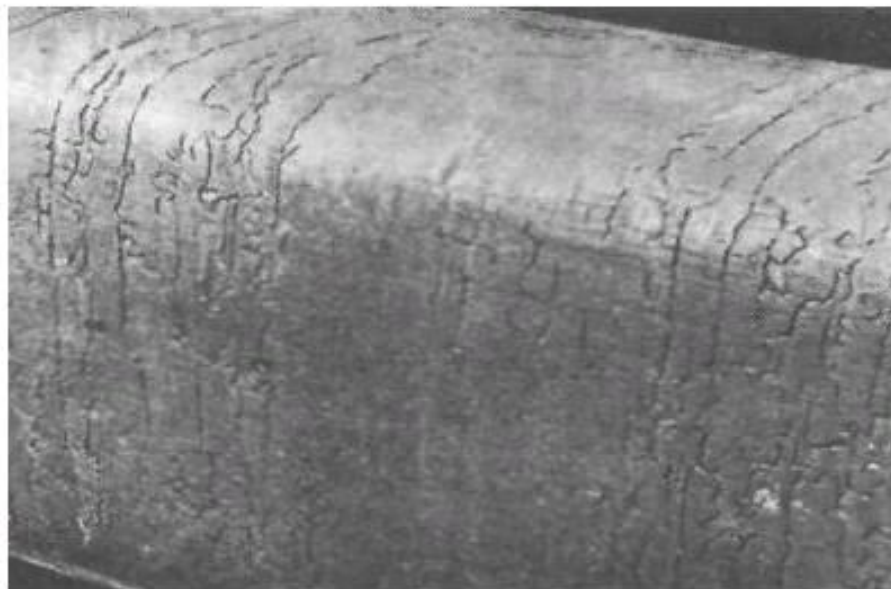
Внешний вид слитка стали 12X18H10T с заворотами корок на поверхности
