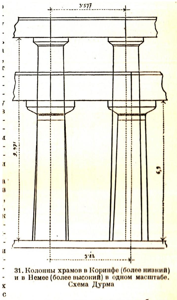
Различные пропорции дорического ордера зависели и от стиля своей эпохи, и от прочности основного строительного материала – естественного камня.
