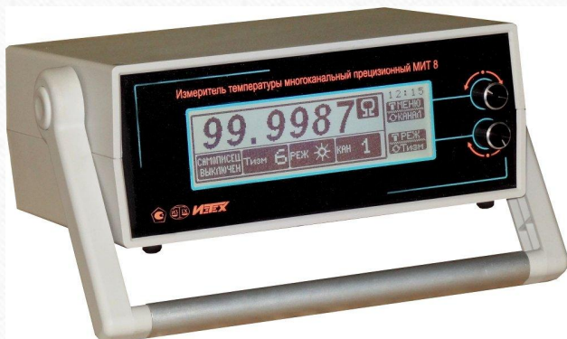
Измеритель температуры многоканальный прецизионный МИТ 8.10М1
