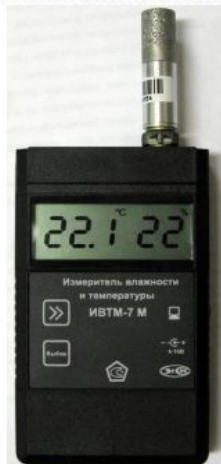
Измеритель влажности и температуры ИВТМ-7 М5-Д
