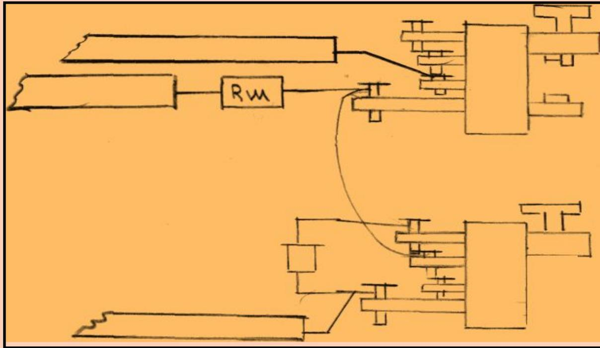
12. Вставить контактное устройство в корпус кнопки управления КУ-92.
