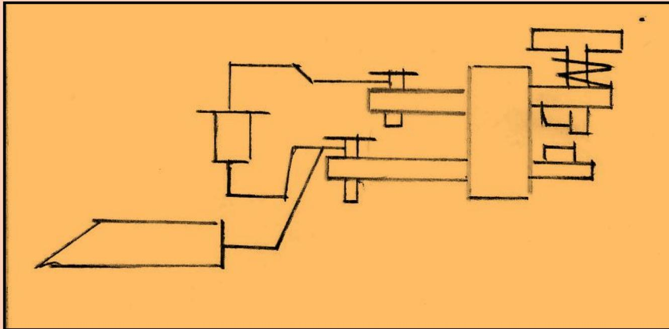
**9. Прикрутить проволочную перемычку: один конец перемычки прикрутить к верхнему правому стоповому контакту, а второй конец перемычки прикрутить к нижнему левому контакту пусковой кнопки (согласно схеме монтажа и подключения кнопки управления КУ-92)**
