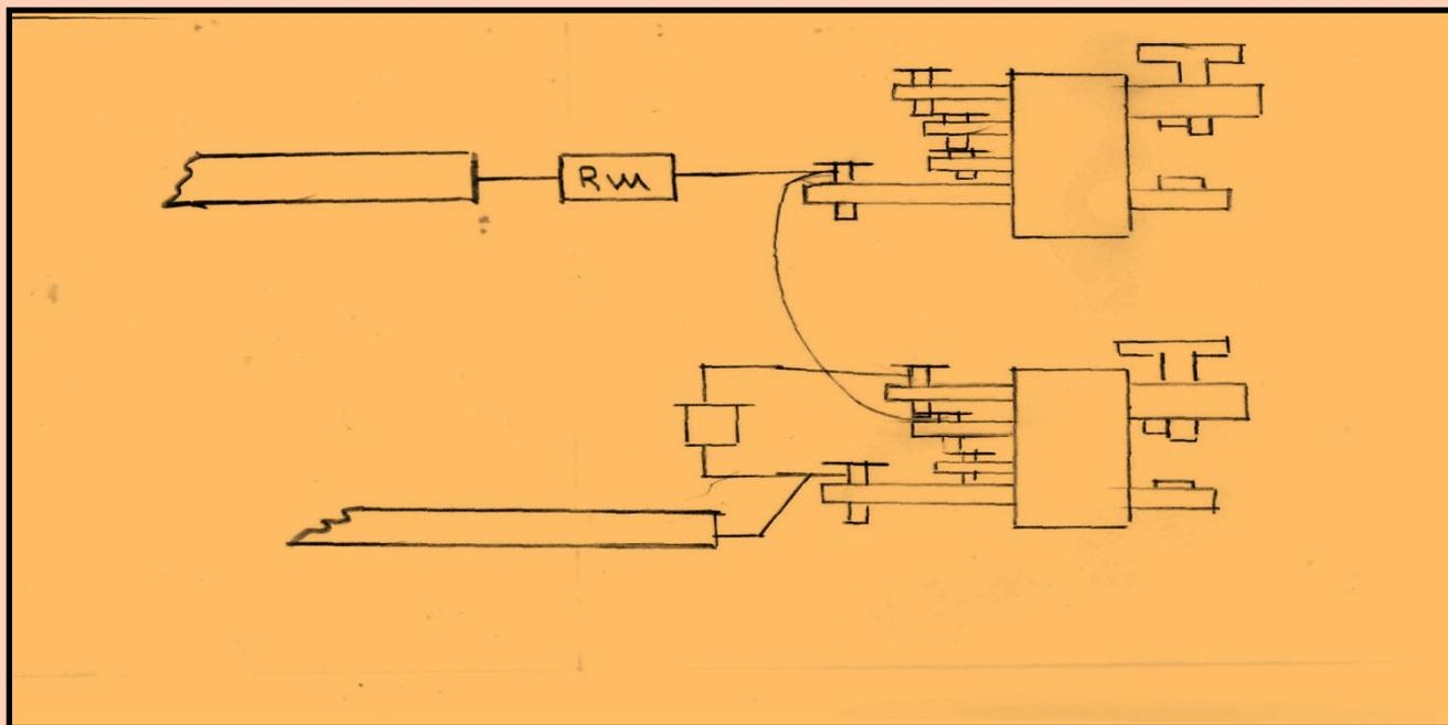
**11. Прикрепить жилу управления к правому нижнему контакту пусковой кнопки (согласно схеме монтажа и подключения КУ-92).**
