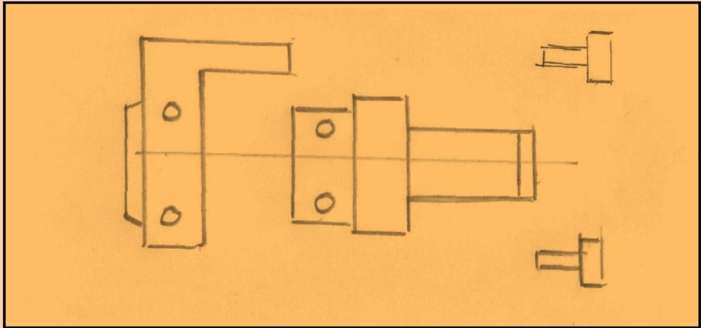
**4. Открутить со стороны вводное устройство и вынуть резиновое кольцо, которое обеспечивает пыле-влаговзрывобезопасность внутри корпуса, обеспечить диаметр нужный по размеру шланговой оболочки.**
