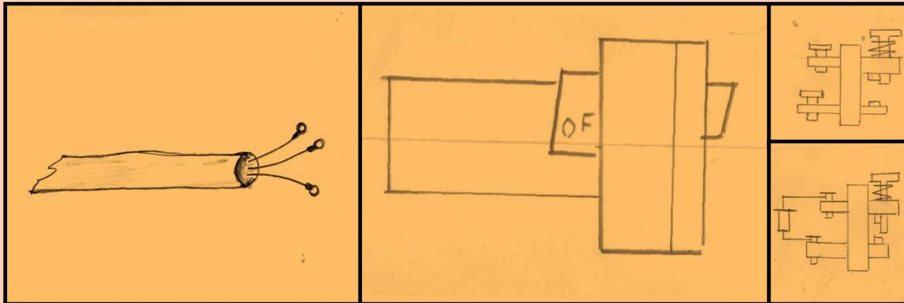
**8. Прикрепить жилу управления к левому нижнему контакту стоповой кнопки (согласно схеме монтажа и подключения кнопки управления КУ-92)**
