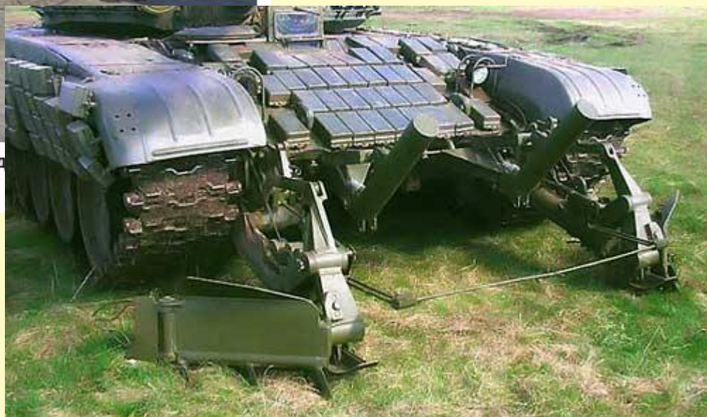
Инженерный танковый минный трал "ТМТ-С" на Межд © Игорь Долгов / Фотобанк Лори
