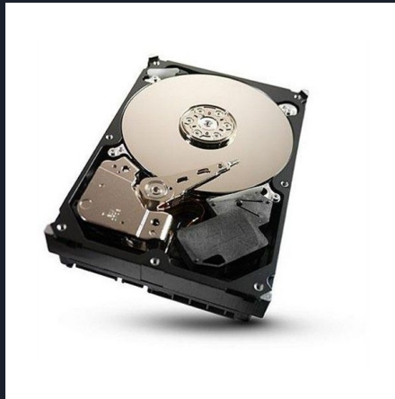
Внешний вид и устройство НЖМД
