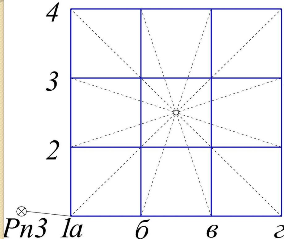
Отметки точек в это случае вычисляются через горизонт прибора.
