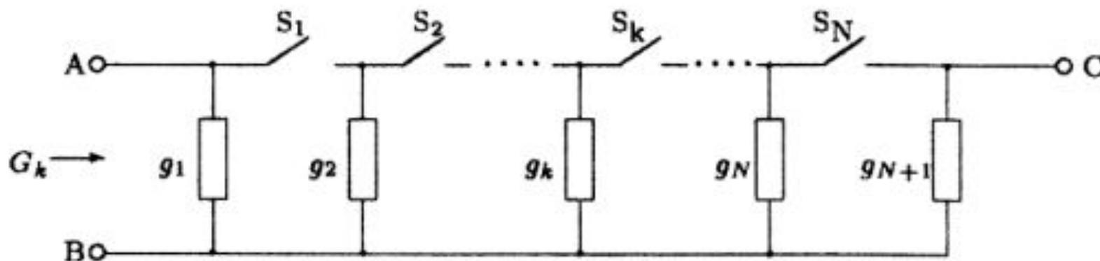
Один из концов каждого резистора соединен общим проводом
