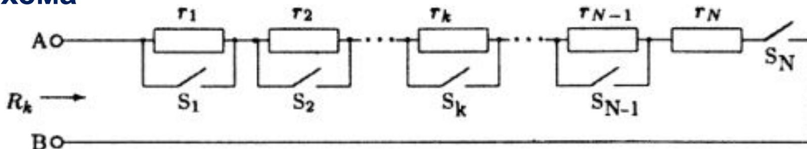
В последовательной схеме все параллельные группы из резистора и ключа соединены последовательно
