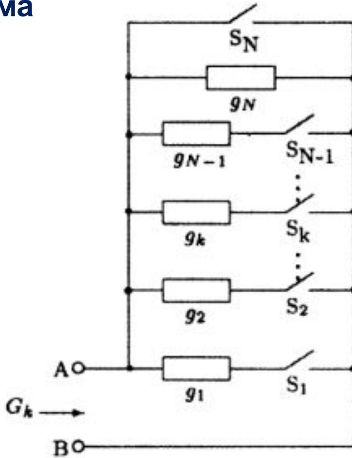
В параллельной схеме все последовательные группы, состоящие из сопротивления с ключом, включены в схему параллельно
