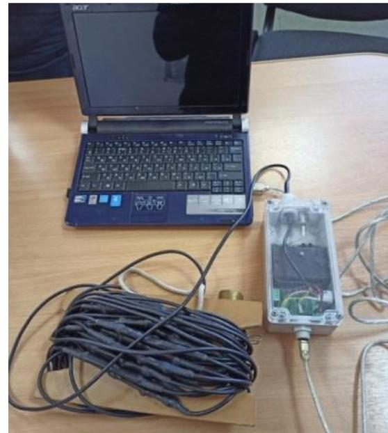
Разработан макет датчика, совместно с ИВЭП были проведены испытания на озере Телецкое в августе 2020-го, в результате которых были получены профили температуры до глубины 10м.
