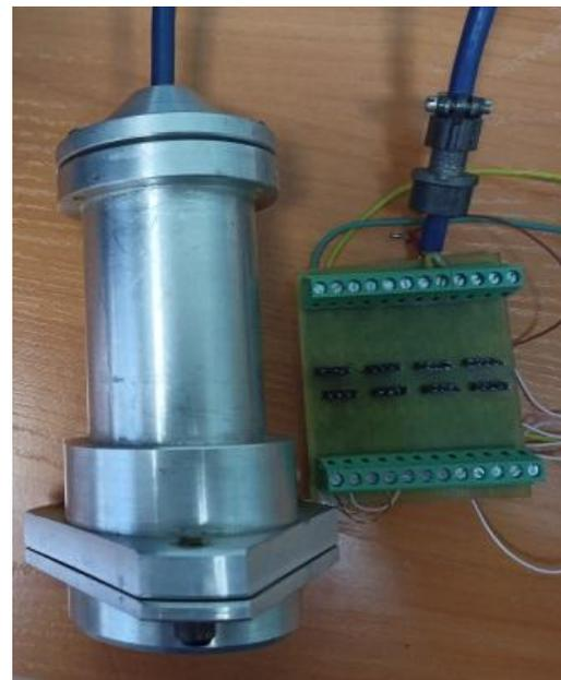
Разработан макет датчика, в настоящее время совместно с ИВЭП проводятся испытания макета датчика, при проведении лабораторных испытаний установлен диапазон измерений оптического сигнала: 200нм – 1150нм.
