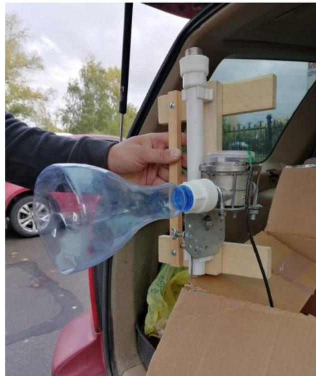
Разработан макет датчика, совместно с ИВЭП были проведены испытания на озере Телецкое в мае 2020, в ходе которых установлена минимальная измеряемая скорость – 2мм/с.
