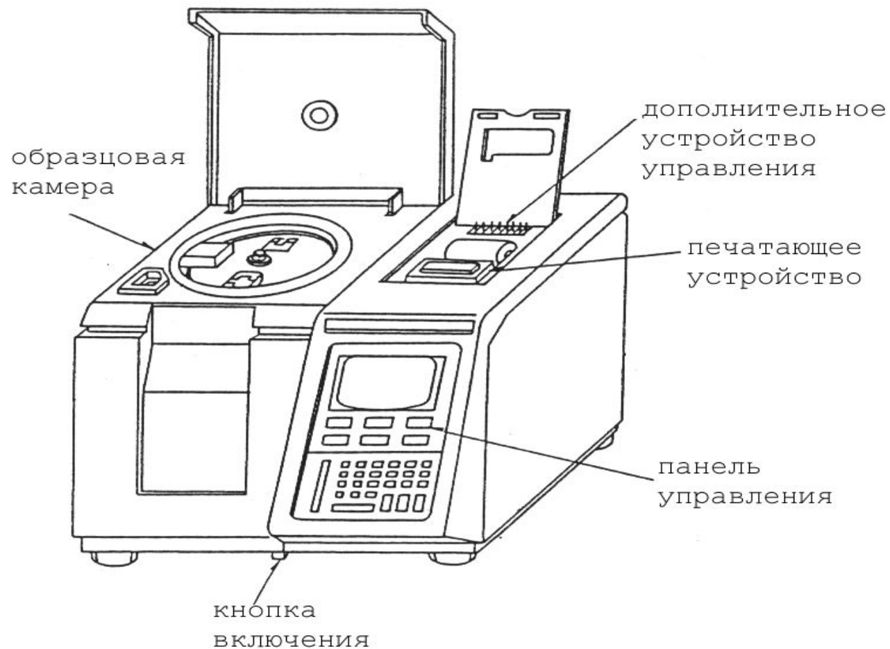
Рис.7.1. Общий вид устройства для определения гранулометрического состава частиц твердой фазы HORIBA CAPA-700.
