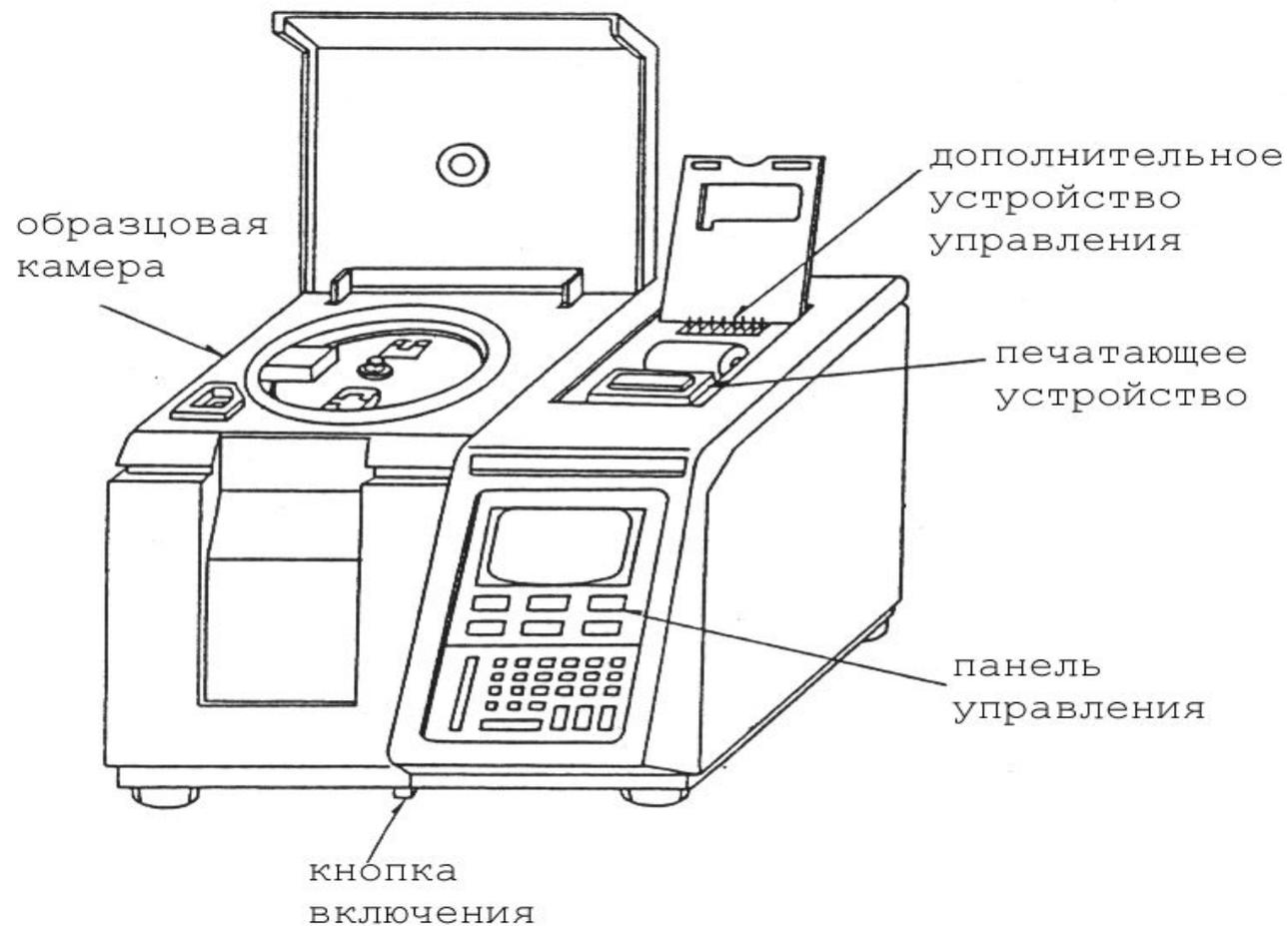
**Рис.7.1. Общий вид устройства для определения гранулометрического состава частиц твердой фазы
