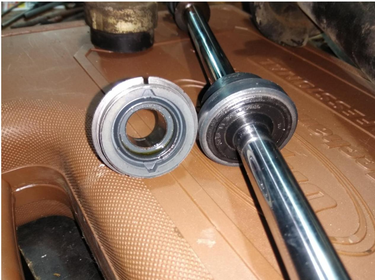
Далее улаживаем донорский сальник – он же пыльник в сборе, в родную обойму. Пыльником к родному пыльнику. Шайбу нужно расточить что бы она подходила на донорский сальник.
