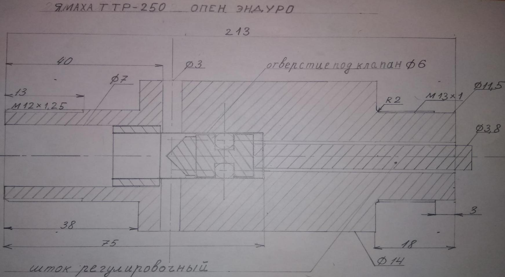
Для сверления самого длинного отверстия под толкатель клапана, использовали сверло по металлу(желтое) на 4мм. К сверлу приварили электрод, для достижения требуемого размера.
