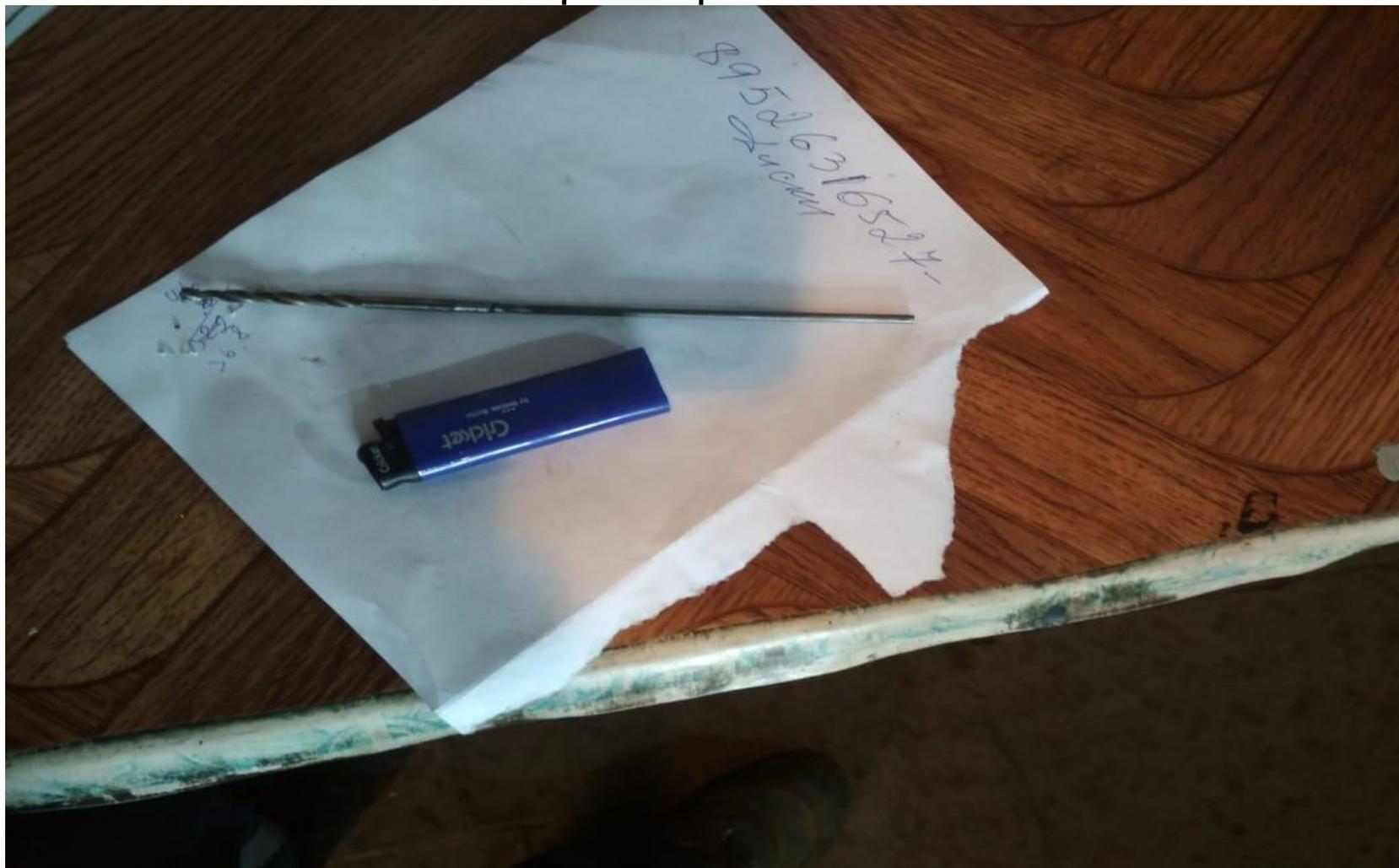
Важно: при сверлении длинного канала, чаще выводить сверло, счищать стружку и смазать маслом.
