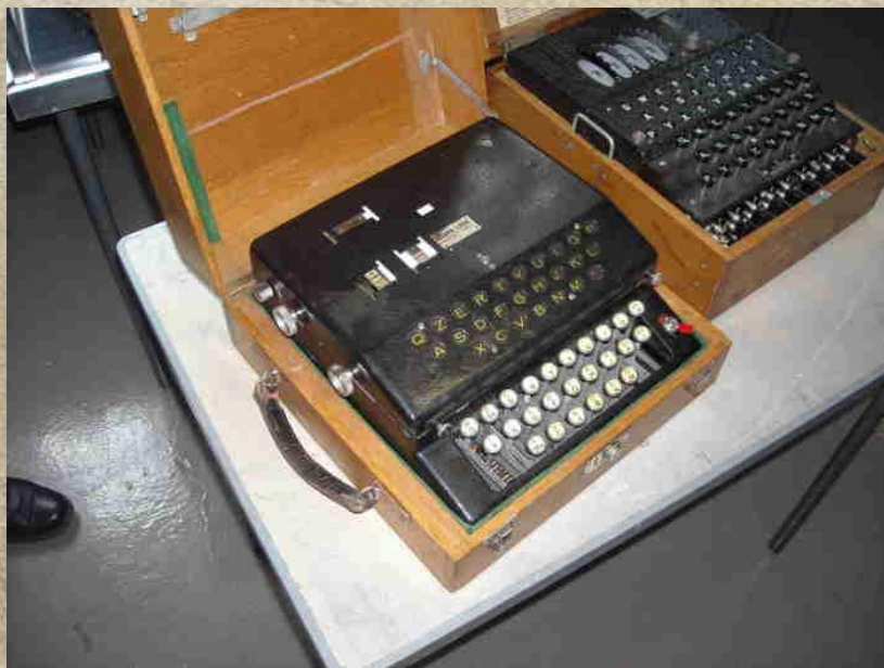
Шифровальная машина К-37 «Кристалл» Вес - 19 кг Принцип многоалфавитной замены
