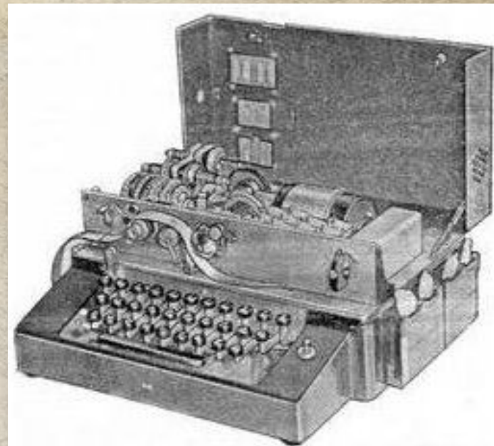
Шифровальная машина М-101 «Изумруд» Вес - 64,5 кг Применялась в дальней бомбардировочной авиации
