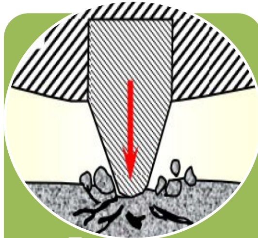
Дробление (шарошечные долота, динамическая нагрузка)
