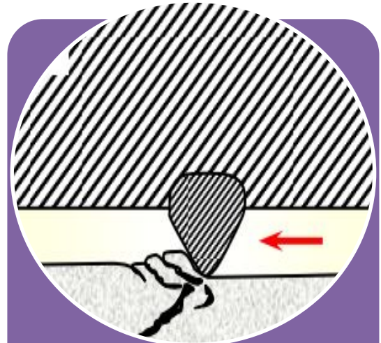
Истирание (алмазные долота, статическая нагрузка)
