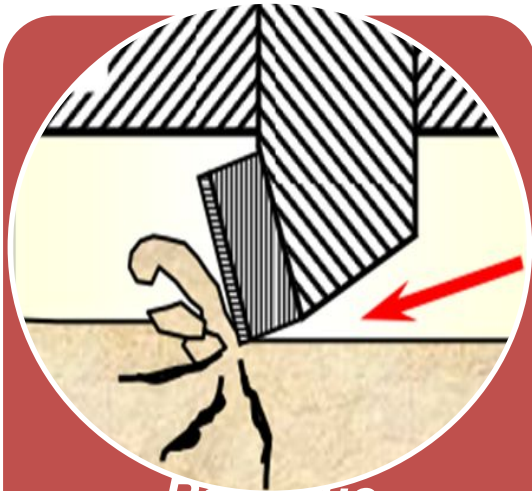
Резание (лопастные и алмазные долота, статическая нагрузка)
