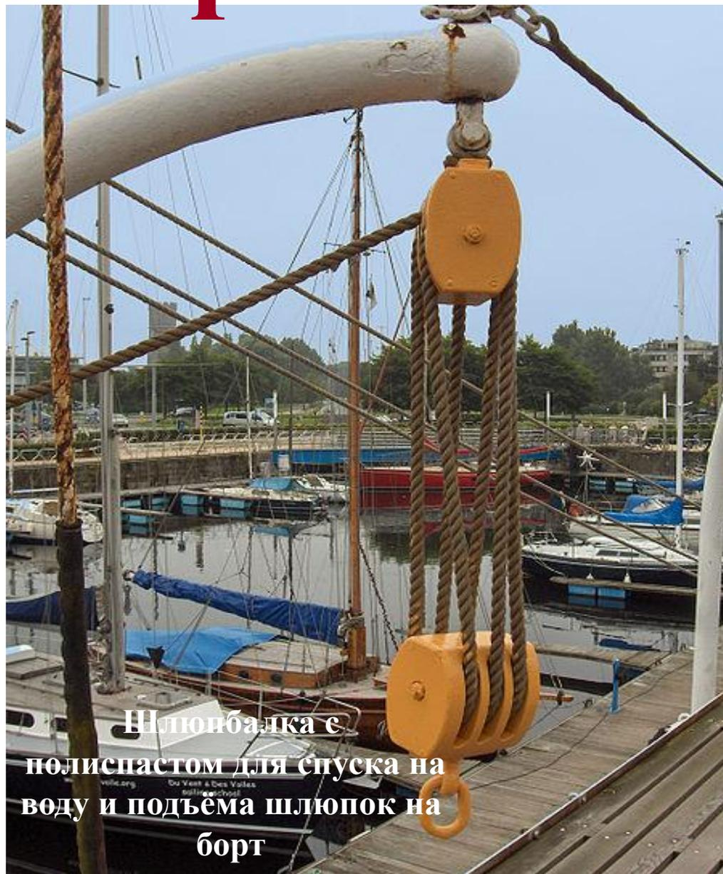
Шлюпбалка с полиспастом для спуска на воду и подъема шлюпок на борт
