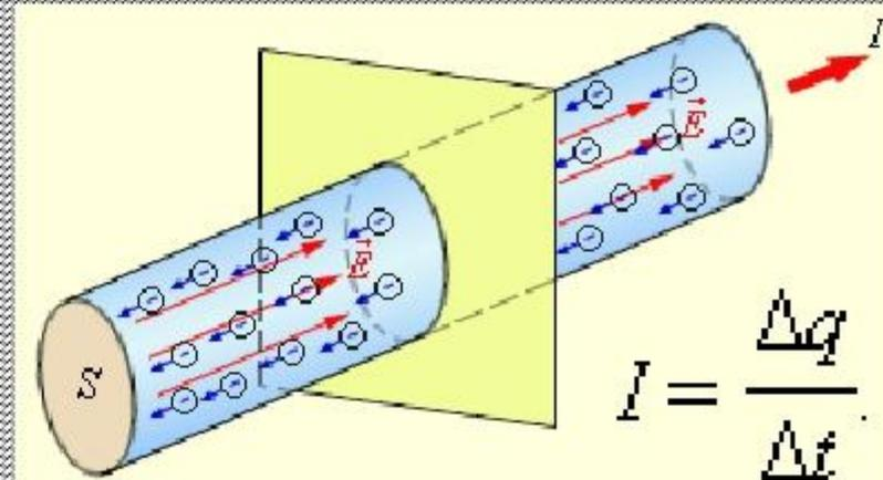
$S$  – площадь поперечного сечения проводника,
