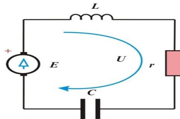
*в) простейшая электрическая схема цепи состоящая из четырёх элементов:  $E$  - источника электрической энергии (ЭДС);  $r$  - сопротивления (резистора);  $L$  - индуктивности (катушки) и  $C$  - ёмкости (конденсатора)*
