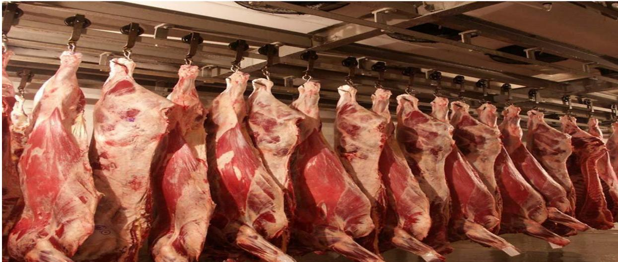
Размороженное мясо поступает в цех на тележках и зачищается на рабочих столах. Зачищенное мясо моют в ваннах с проточной водой (20-30 °С) или в подвешенном состоянии щетками (щетками-душами). Затем для охлаждения мясо обмывают холодной водой (12-15 °С).
