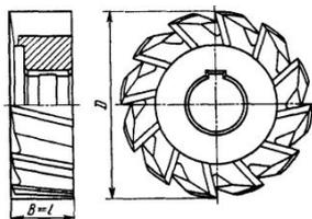
Рис. 14.4. Торцовая фреза
