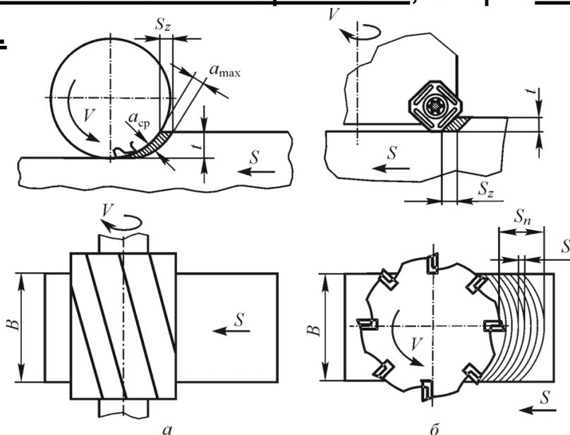
**Процесс фрезерования** отличается от других процессов резания тем, что каждый зуб фрезы за один ее оборот находится в работе относительно малый промежуток времени и срезает стружку переменной толщины.
