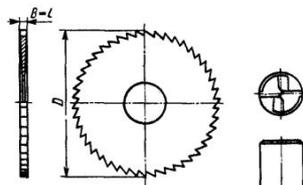
Рис. 14.8. Прорезная фреза
