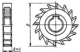
Рис. 14.5. Дисковая трехсторонняя фреза
