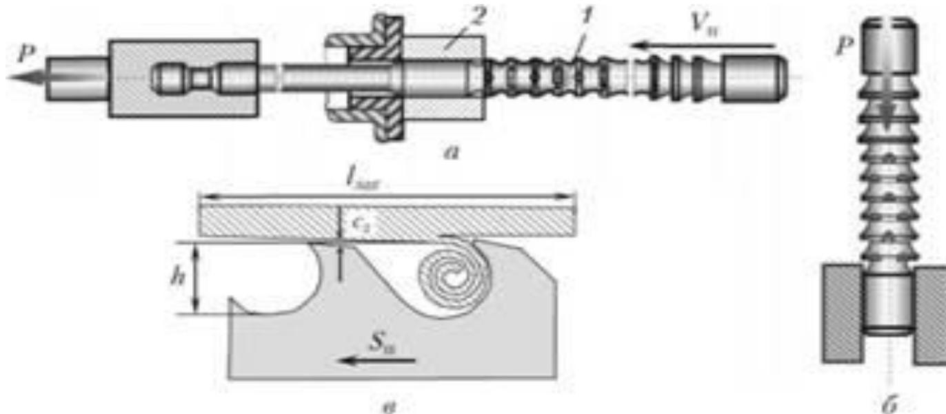
**Внутреннее протягивание** применяют для обработки различных отверстий, например квадратных, многогранных, шлицевых с различными профилями прямых и винтовых канавок, а также шпоночных и других фигурных пазов в отверстиях детали
