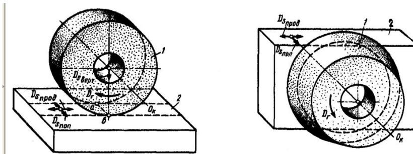
Схема плоского шлифования
