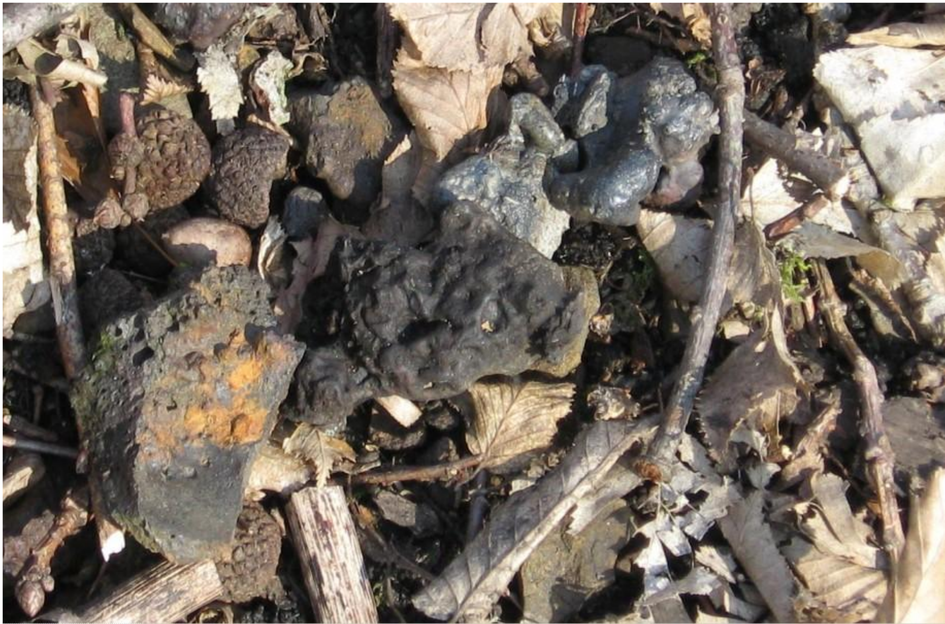
Крица – полуфабрикат металлургии железа. Сочи. Аналоги найдены в камере дольмена Хамышек
