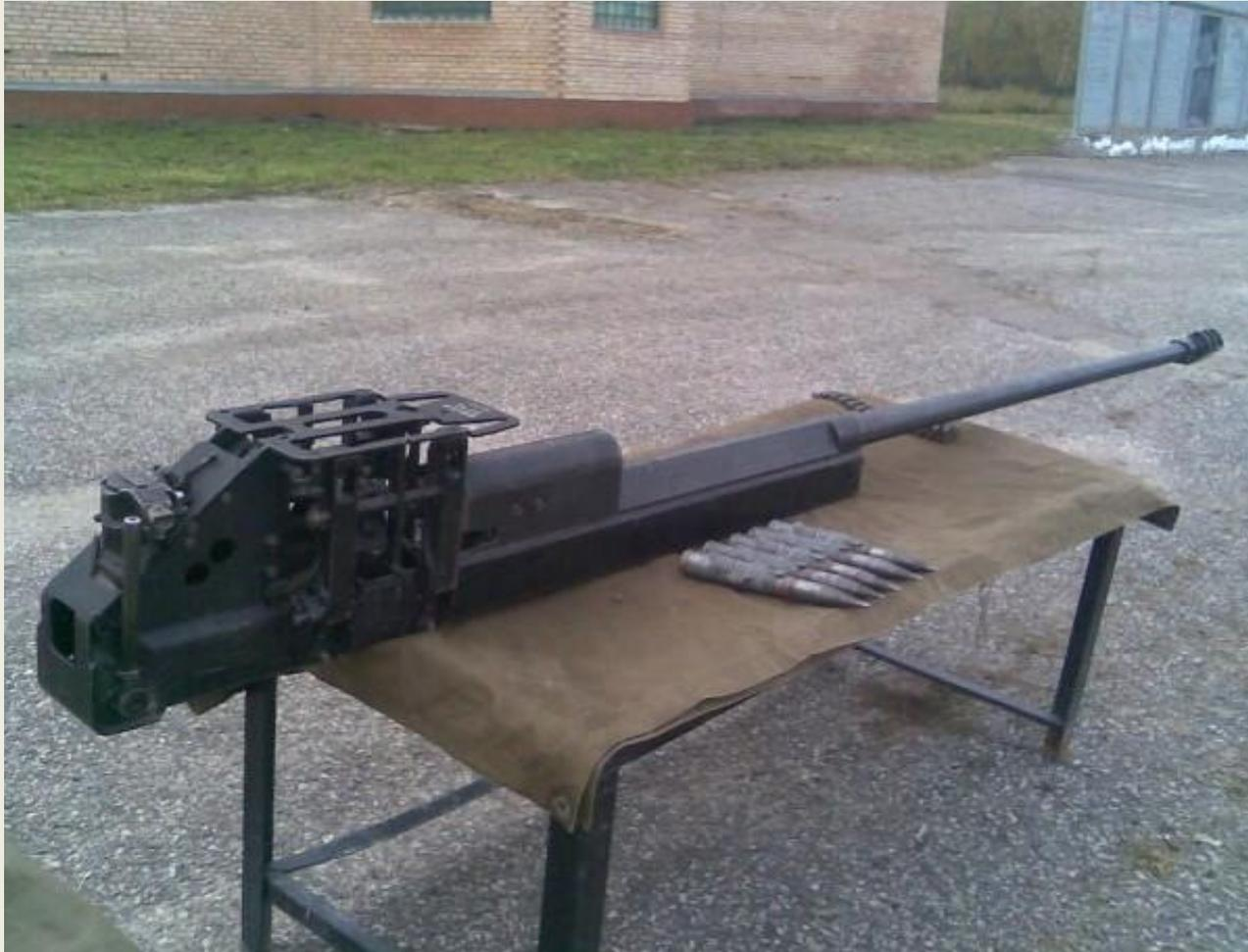
**Назначение:** 30-мм автоматическая пушка 2А42 предназначена для поражения наземных (легкобронированные средства, живая сила противника и т. д.) и воздушных целей. Питание пушки - двухленточное.
