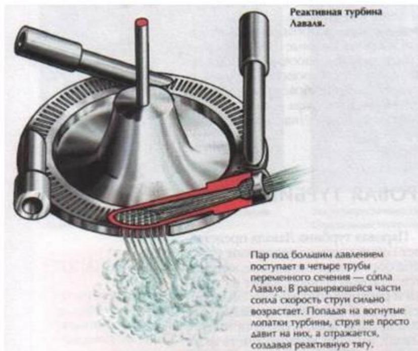
Паровая турбина Лавала представляет собой колесо с лопатками. Пар под большим давлением вырывается из трубы (сопла), давит на лопатки и раскручивает колесо.
