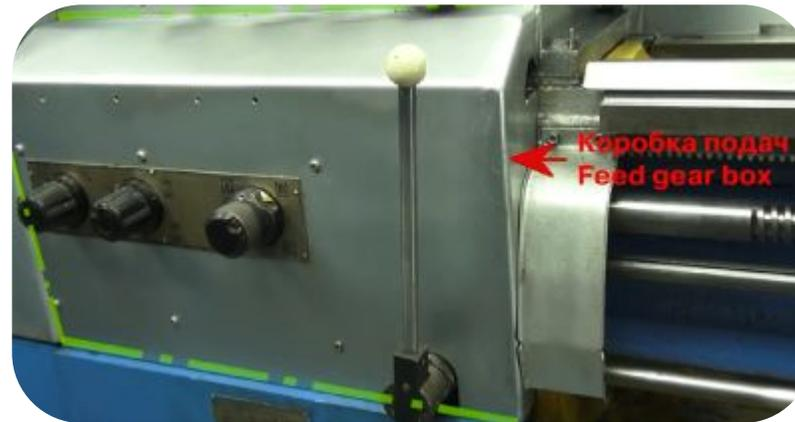
Элемент станка осуществляющий перемещение режущего инструмента в продольном, поперечном и наклонном направлении
