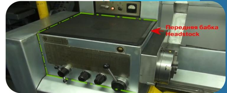
Расположенные в ней узлы предназначены для регулирования скорости вращения детали
