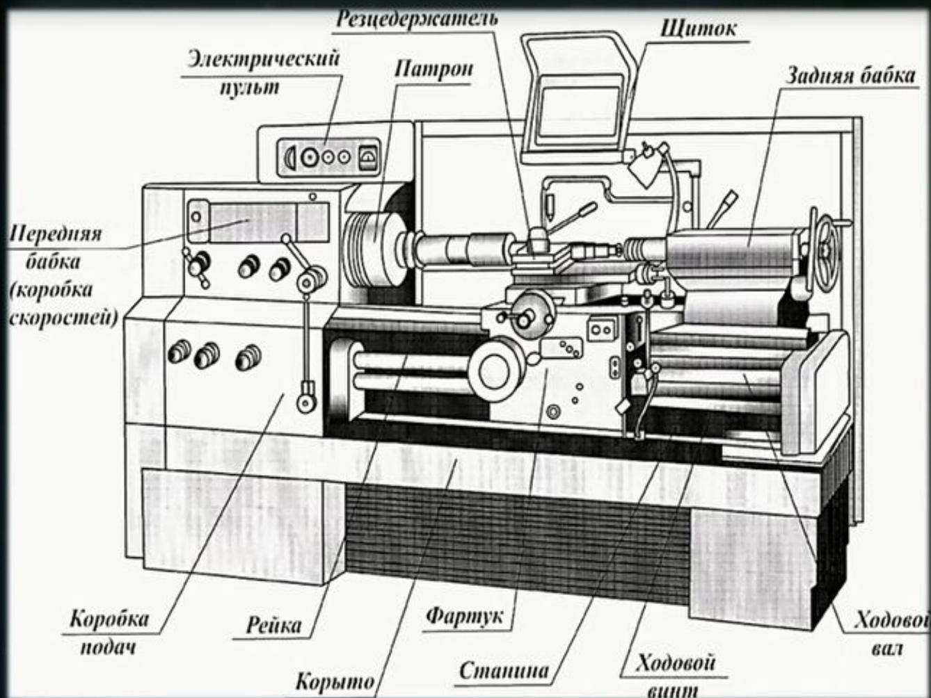
**Ходовой винт** используется для передачи движения от коробки подач к каретке суппорта только при нарезании резьбы, а **ходовой вал** — при выполнении всех основных токарных работ.
