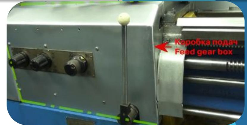
Орган управления станка которая используется при регулировании подачи суппорта
