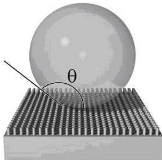
Слева - капля не смачивает поверхность, состоящую из нановолосков, и поэтому не растекается по ней. Справа - схематическое изображение поверхности, похожей на массажную щётку;  $\theta$  - краевой угол, величина которого говорит о смачиваемости поверхности: чем больше  $\theta$ , тем меньше смачиваемость.
