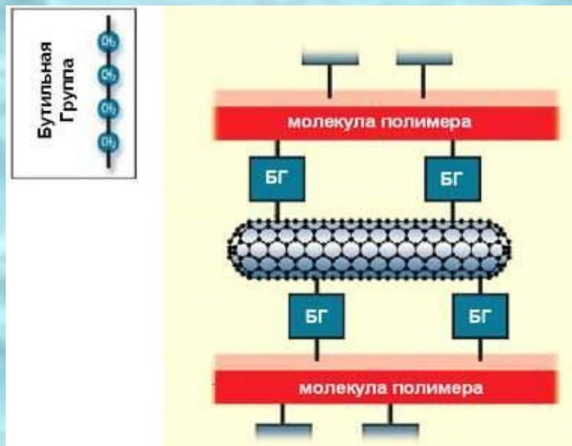
Нанотрубки делают полимерные материалы более прочными
