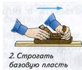
2. Стругать базовую плоскость
