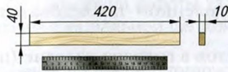
1. Выбрать заготовку на две детали
