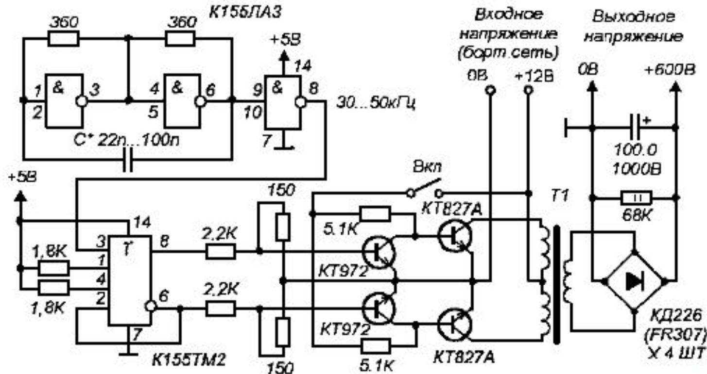
**Предупреждение. На выходе преобразователя вырабатывается высокое напряжение, опасное для жизни, поэтому обращаться с ним следует предельно внимательно.**
