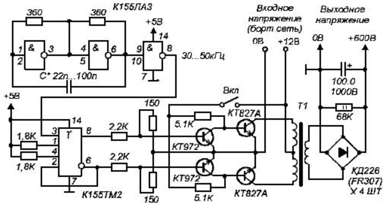
На элементах микросхемы К155ЛА3 собран задающий генератор на частоту 30...50 кГц, далее делитель и формирователь противофазных импульсов на К155ТМ2 и, собственно, преобразователь высокого напряжения на двух транзисторах КТ972, которые в их отсутствие можно заменить на КТ3102Е, и двух выходных транзисторах КТ827А.
