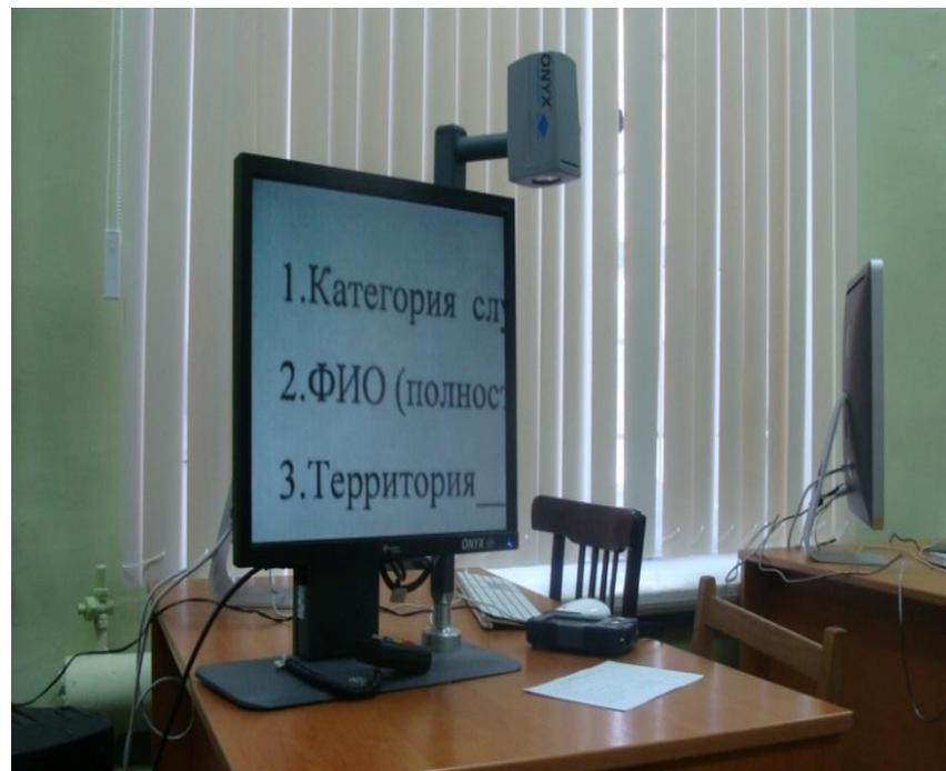
**Читающая машина** обеспечивает незрячему человеку возможность чтения любых плоскочечатных текстов с помощью синтеза речи
