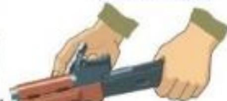
Надеть пенал на выступ защелки газовой трубки, повернуть защелку от себя до вертикального положения и снять газовую трубку
