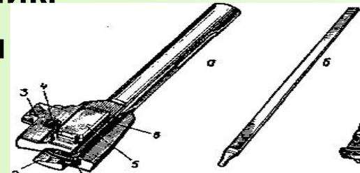
**Возвратный механизм** служит для возвращения затворной рамы с затвором в переднее положение.
