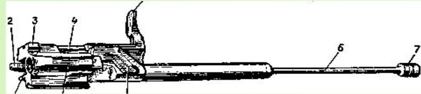
**Затвор** служит для досылания патрона в патронник, закрывания канала ствола, разбивания капсюля и извлечения из патронника гильзы (патрона).
