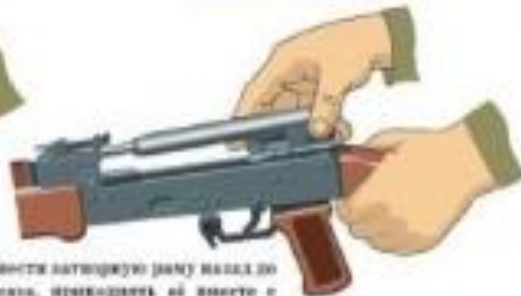
Отделение затворной рамы с затвором
