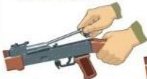
Подать вперед направляющий стержень возвратного механизма, приподнять его заднюю часть и вынуть механизм
