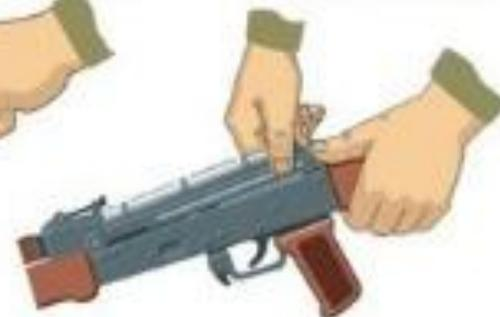
Одной рукой обхватить шейку приклада, большим пальцем нажать на выступ направляющего стержня возвратного механизма, другой рукой приподнять и отделить крышку
