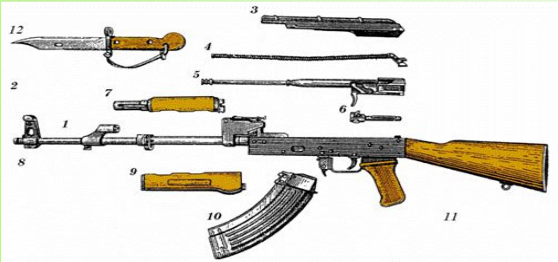
1 - ствол со ствольной коробкой, прицельным приспособлением и прикладом; 3 - крышка ствольной коробки; 4 - возвратный механизм; 5 - затворная рама с газовым поршнем; 6 - затвор; 7 - газовая трубка со ствольной накладкой; 8 - шомпол; 9 - цевье; 10 - магазин; 11 - пенал с принадлежностями; 12 - штык-нож; Также: ударно-спусковой механизм, дульный тормоз-компенсатор или пламегаситель.
