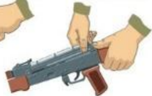
Отделение крышки ствольной коробки
