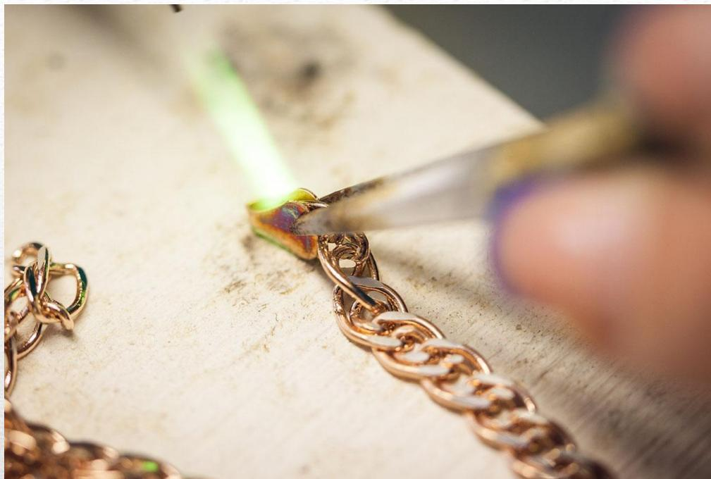
Одним из первых применений лазеров в ювелирной отрасли были операции ремонта различных изделий с помощью лазерной сварки. Примером применения в серийном массовом производстве лазерной сварки является лазерная сварка цепей при их производстве.
