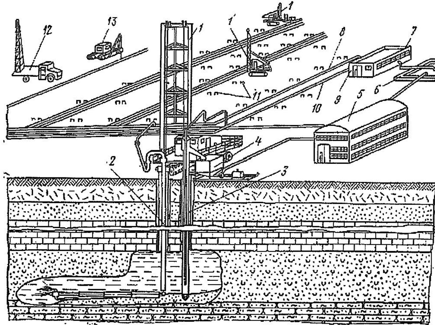
**Рис. 19.1 Технологическая схема скважинной гидродобычи полезных ископаемых:**
