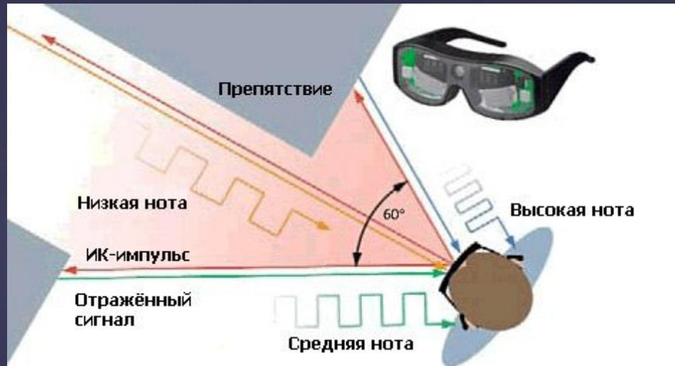
Лазерный сенсор Siemens проверяет всю местность в пределах своего обзора по 25 раз в секунду.
