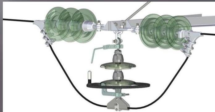
Натяжные гирлянды изоляторов предусматриваются одноцепными. Для провода АС 120/19 натяжные зажимы приняты прессуемые. Количество изолирующих натяжных подвесок провода – 30 шт, поддерживающих подвесок – 3шт.
