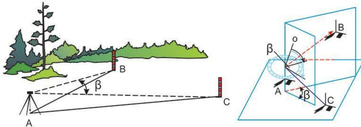
Измерение горизонтального угла способом приемов
