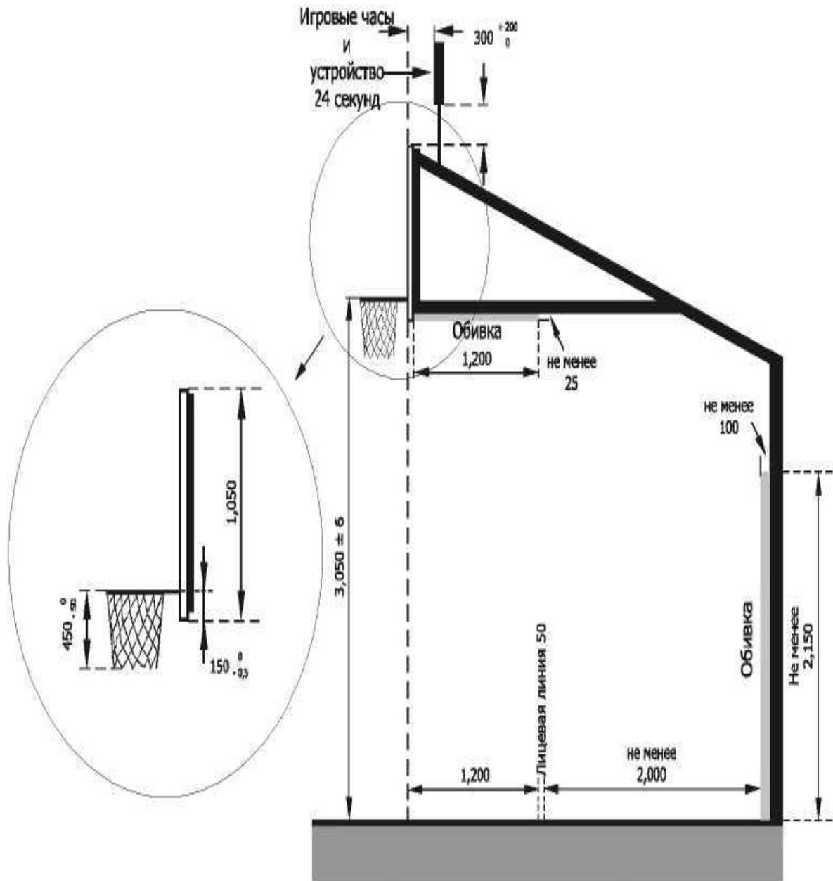
Рис. 1 Конструкция щита
