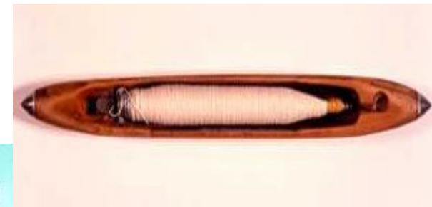
В 1730 году был усовершенствован ткацкий станок! Механик и ткач **Джон Кэй** изобрел для него новый челнок. Это техническое усовершенствование ускоряло процесс ткачества, так как позволяло мастеру одним нажатием педали пропускать челнок между нитями основы вместо того, чтобы вручную протаскивать его, как это было ранее.
