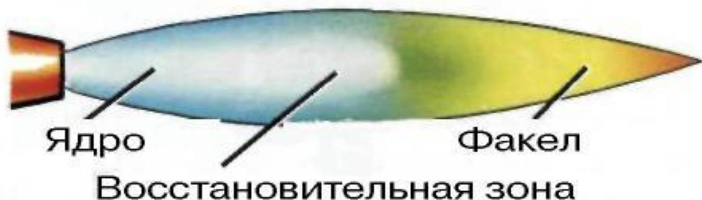
**Ядро** теряет резкость очертания, на конце появляется зеленый **венчик**, **восстановительная зона** бледнеет и почти сливается с ядром. Факел желтеет. Используют для сварки чугуна, наплавки твердыми сплавами
