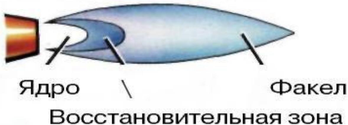
Ядро конусообразное, укороченное, имеет менее резкие очертания, бледнеет. Пламя - синевато-фиолетовое, горит с шумом. Все зоны сокращаются по длине. Окисляет металл. Шов получается хрупким и пористым. Используют при сварке латуни
