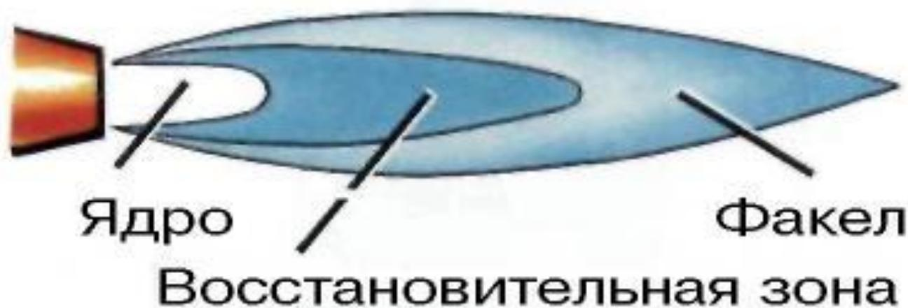
Ядро - резко очерченное, цилиндрической формы с плавным закруглением, ярко светящейся оболочкой, четко выражены все три зоны. Используют для сварки большинства сталей, сплавов и цветных металлов
