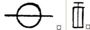
·Головка-затвор с электроприводом
