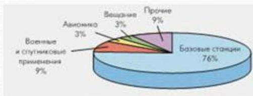
Области применения твердотельных СВЧ-компонентов мощностью свыше 20 Вт
