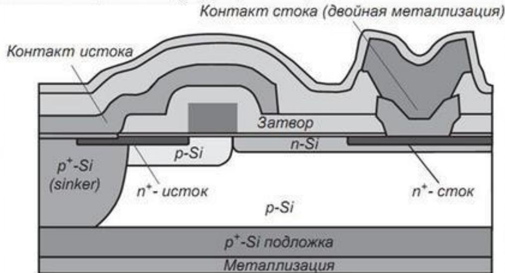
Еще в 2000 году компания Motorola представила LDMOS-транзистор с длиной затвора 0,6 мкм, толщиной подзатворного окисла 40 нм и пробивным напряжением исток-подложка 65 В. При суммарной ширине затвора 480 мкм транзистор работал с выходной мощностью 220 Вт на частоте 2,12 ГГц при рабочем напряжении 28 В, демонстрируя КПД 46%.
