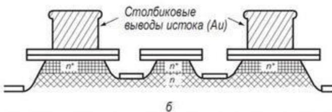
Конструкция мощного СВЧ GaAs полевых транзистора с затвором в виде барьера Шоттки
