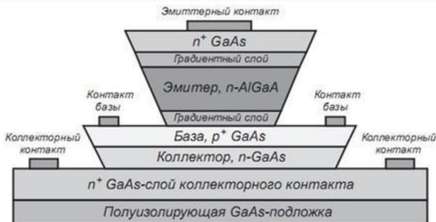
Типовая структура биполярного транзистора с эмиттерным гетеропереходом на основе арсенида галлия ГБТ на GaAs
