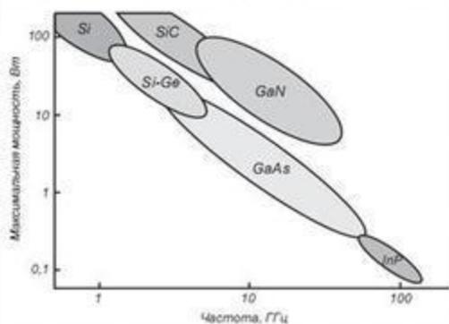
Зависимость максимальной мощности от частоты для приборов на основе различных полупроводниковых материалов
