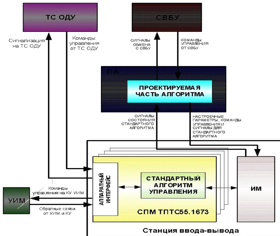
ПА – процессор автоматизации; ТС ОДУ – технические средства оперативно диспетчерского управления (мозаичные щиты); СВБУ – система верхнего блочного уровня; КУ – коммутационное устройство; ИМ – интерфейсный модуль; СПМ – модуль связи с процессом.
