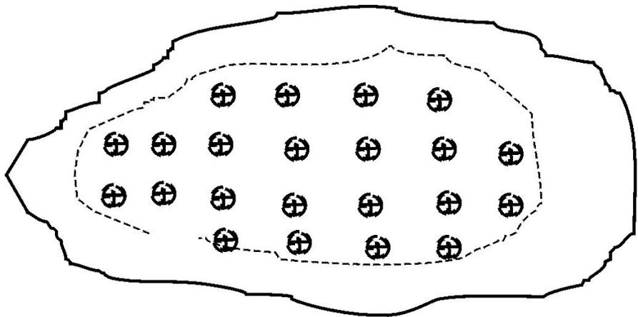
Рис.5.5. Размещение скважин в сводовой части залежи
