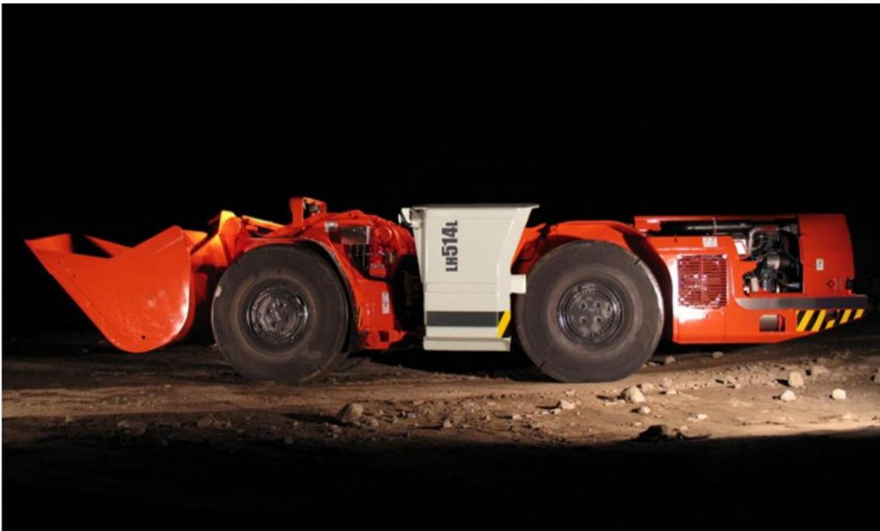
Погрузка , транспортировка , отгрузка горной массы
