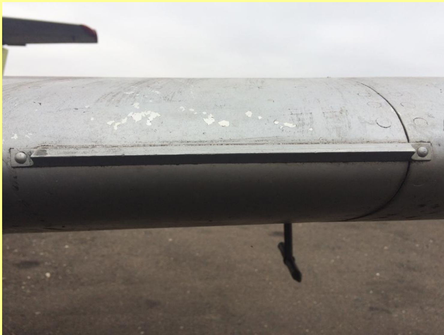
Турбулизатор на передней кромке, перед элероном, на самолёте L-29
