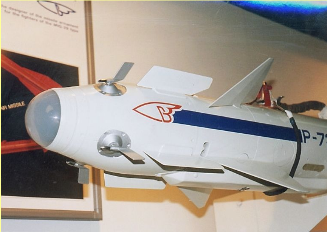
Флюгерный датчик угла атаки. Размещение ДАУ-Ф на ракете К-73
