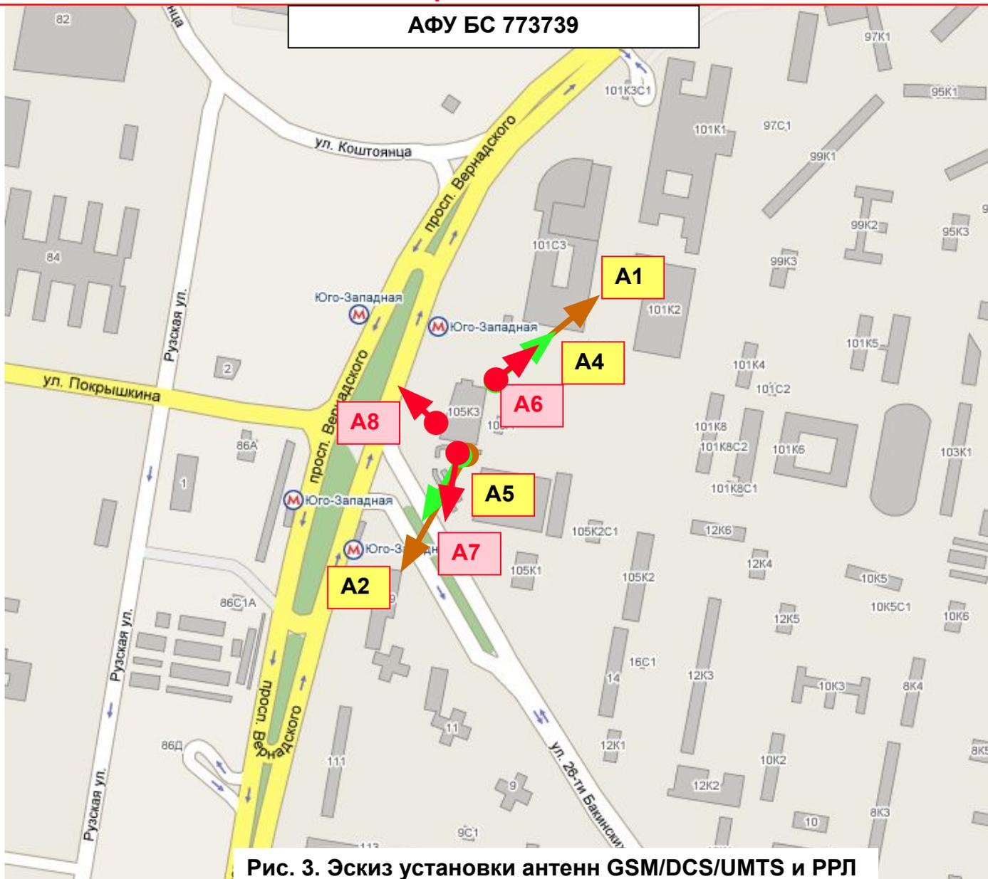
Рис. 3. Эскиз установки антенн GSM/DCS/UMTS и PPL
