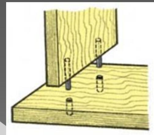
На предприятиях процесс соединения деталей с помощью шкантов механизирован. Детали и шканты там изготавливают станочники, а соединяют сборщики.
