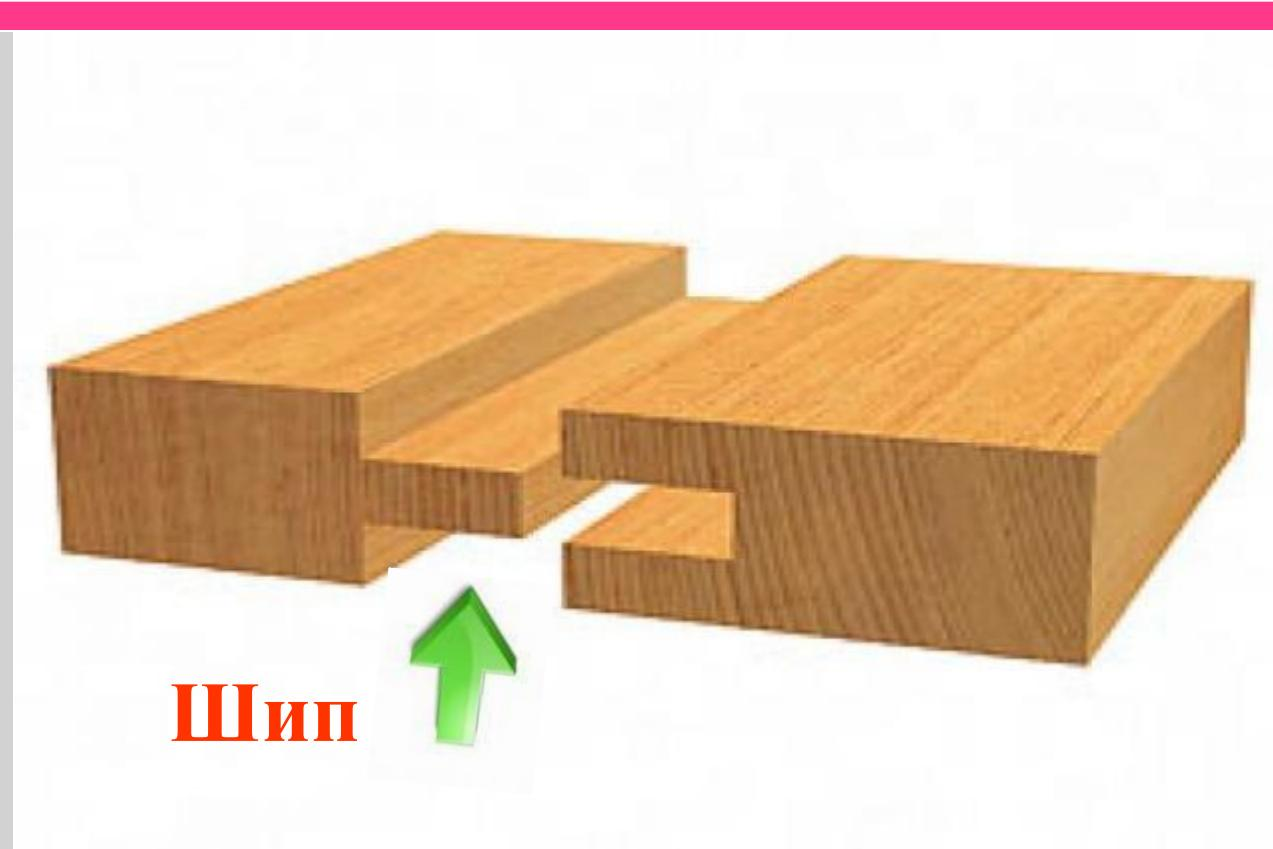
**Проушиной называют паз на торце детали, соединяемый с шипом.**
