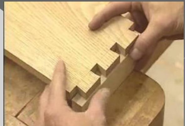
**Шиповые соединения после освобождения от сжатия строгают, чтобы убрать неровности на стыках, застывшие клеевые потеки и др. Строгают, закрепив изделие клиньями на верстаке, с двух сторон на полный размах рук сквозным (полным) движением рубанка.**
