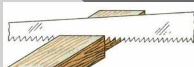
Для получения **шипа** провести поперечное спиливание по удаляемым частям заготовки.
