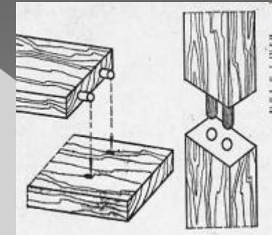
Для упрочнения соединений применяют **нагели**. Эти цилиндрические деревянные стержни, которые забивают в отверстие детали параллельно торцу, чтобы в них ввинтить шурупы, так как шуруп, ввинченный непосредственно в торец, плохо держится в древесине. С помощью нагелей упрочняют и шиповые соединения. Пред забиванием нагель немного заостряют и смазывают клеем.
