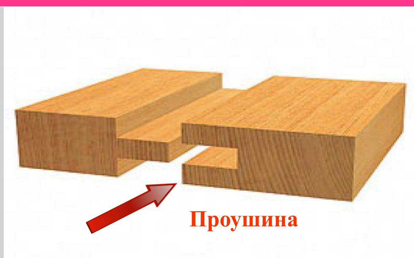
**Гнездом называют отверстие в другой детали, которое соединяется с шипом.**
