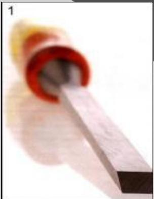
Предназначено для долбления гнезд и проушина. По его ручке наносят удары киянкой. Поэтому для предохранения ручки от раскалывания на нее насаживают еще одно металлическое кольцо. Рабочая часть долота имеет форму клина с углом 35°.
