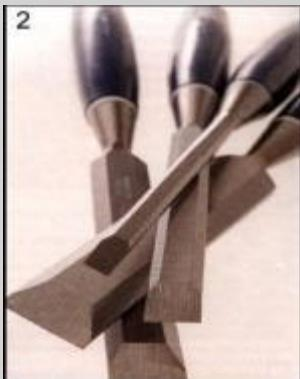
Применяется для зачистки шипов, гнезд и проушина, срезания фасок, подрезки подгоняемых деталей. Кроме того, стамеской можно выдавливать гнезда в тонких деталях. Рабочую часть стамески затачивают под углом 20...25°.
