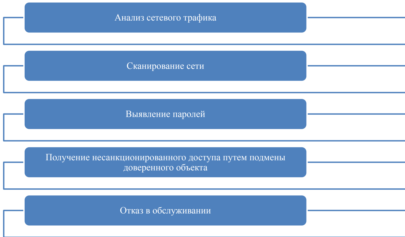
Рисунок 5 – Уязвимости, с помощью которых могут быть реализованы угрозы несанкционированного доступа по каналам связи
