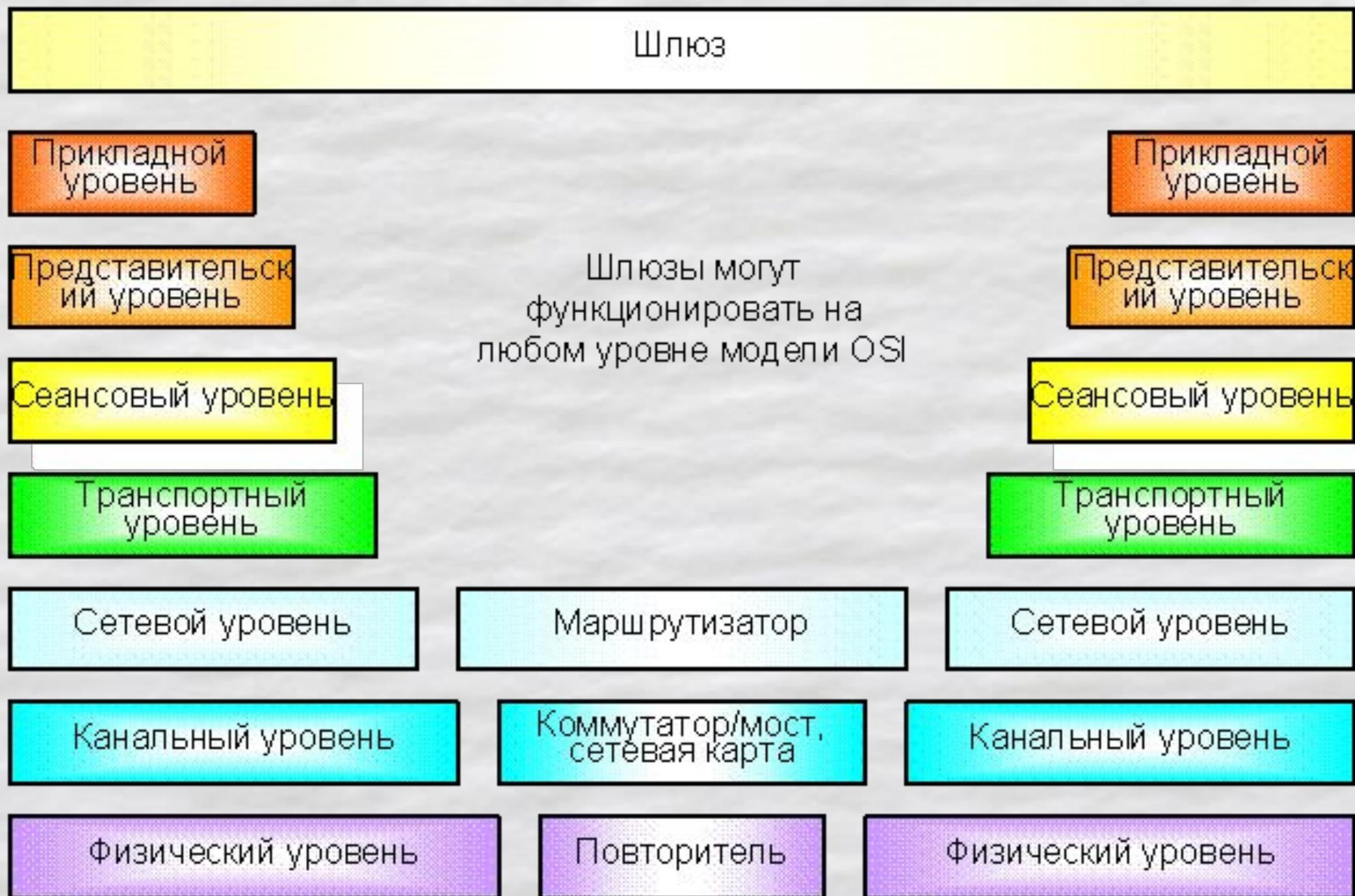
**Физический уровень определяет характеристики физической сети передачи данных, которая используется для межсетевого обмена. Это такие параметры как: напряжение в сети, сила тока, число контактов на разъемах и т.п.**
