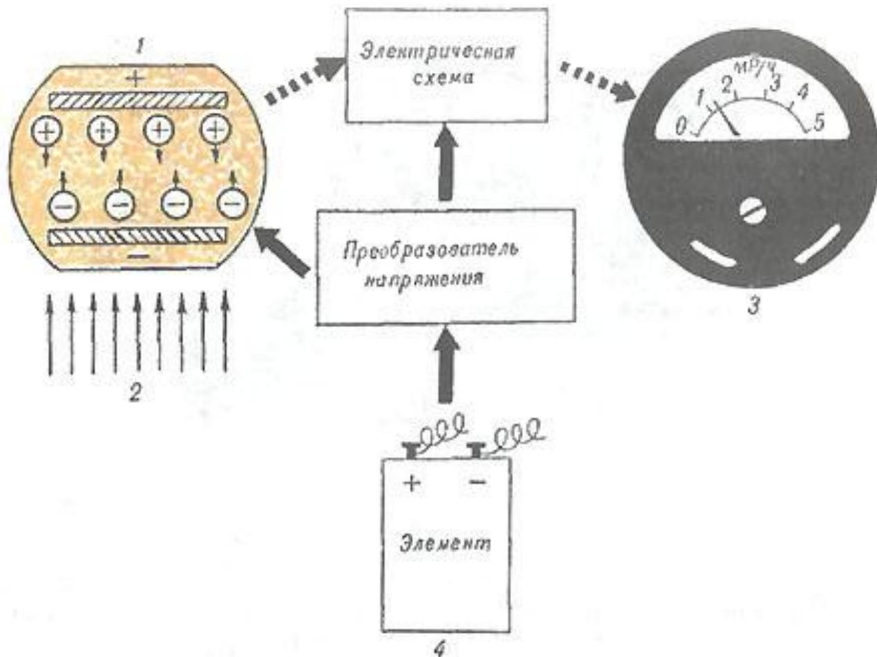
1) Детектор частиц (также его принято называть ионизационной камерой)
