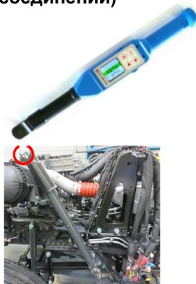
3. После замера моментов сканирует VIN номер автомобиля (узла)
