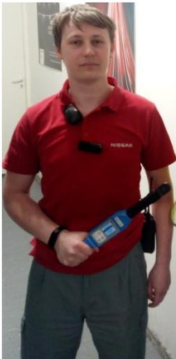
2. Производит замер момента затяжки соединения (группы соединений)
