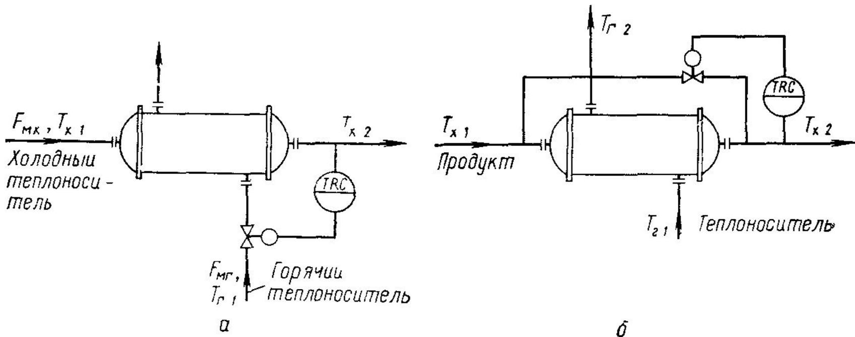
Рис. 8.7. Схемы регулирования поверхностных теплообменников воздействием на расход горячего теплоносителя (а) и байпасированием холодного теплоносителя (б)
