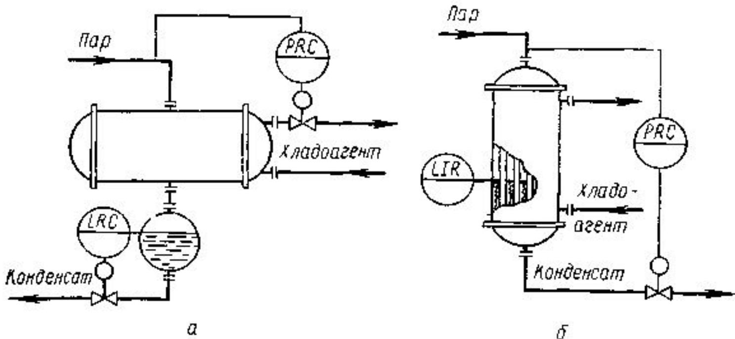
Рис. 8.9. Схемы регулирования работы конденсаторов путем воздействия на расходы хладоагента (а) и конденсата (б)
